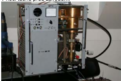
obr. PA s TH327 1,5kW výkonu 1296 MHz
